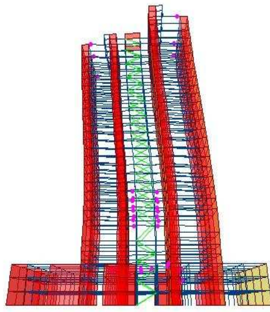
Figura 22 EDIFICIO ROTULADO CON DISIPADORES
